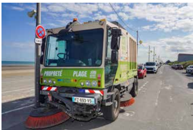
Nettoyage mécanique des digues promenades
